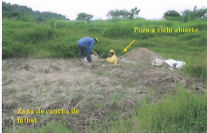
Fotografía 5. Pozo a cielo abierto (PCA), en la zona de la cancha de fútbol de la Residencial Santa Lucia.
