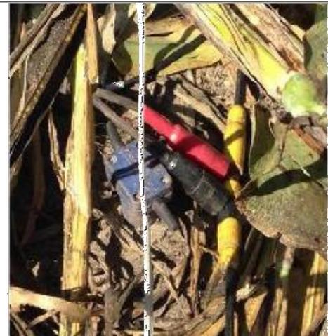
Figura 4 – Equipos empleados durante la fase de adquisición (Sismógrafo Geometrics 24 canales y geófono vertical)
