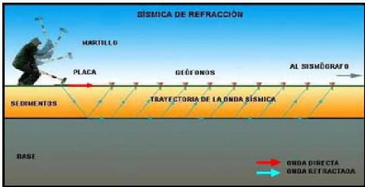
Figura 2 – Levantamiento de sismica de refracción
