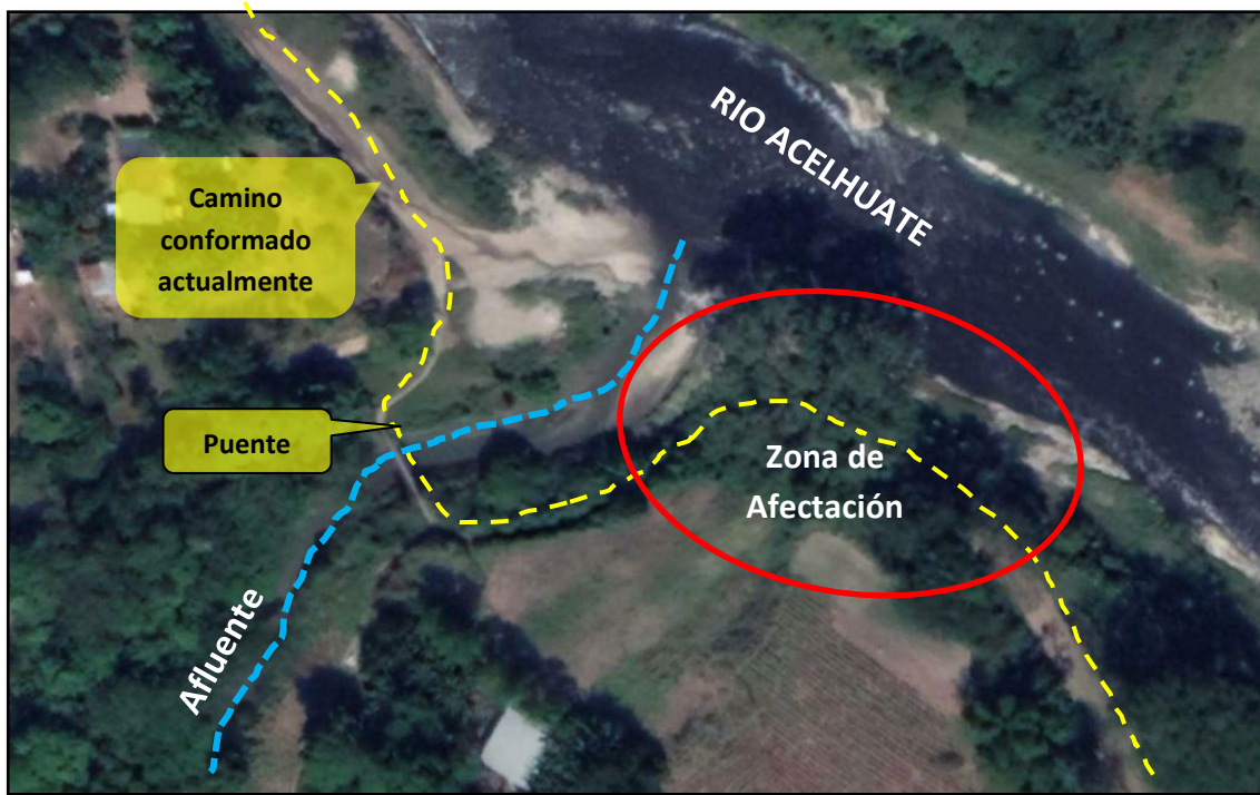
Imagen N°2. Zona de afectación por aumento de cauce del rio
