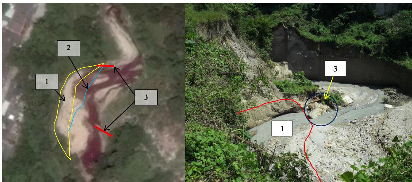
Imagen 16. Esquema general de trabajos de protección propuestos en margen cóncava de meandro entre final Calle Veracruz y Pasaje San Miguel. (1) Área crítica de conformación de terraza; (2) Área óptima de conformación terraza protección; (3) Restos de muros guarda nivel a remover. (Continuación).
