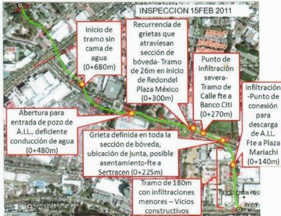
Figura 5: Daños significativos encontrados en tramo inspeccionado el 15 de Febrero de 2011.
