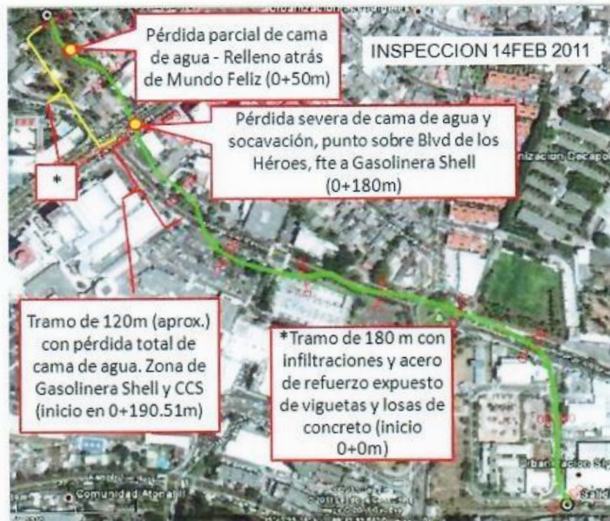
Figura 4: Daños significativos encontrados en tramo inspeccionado el 14 de Febrero de 2011.
