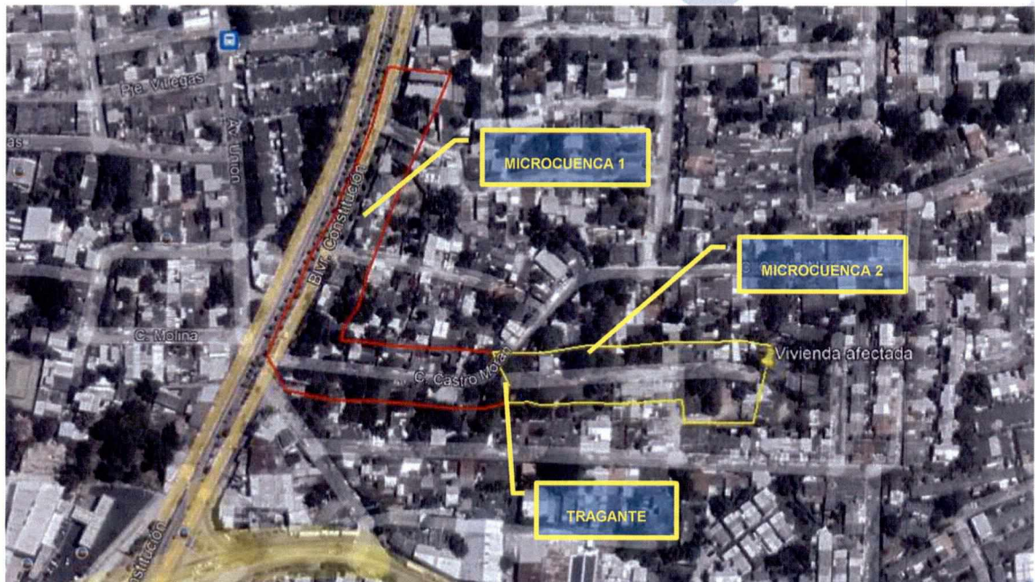
Figura 2. Microcuencas urbanas que descargan en el canal existente.
