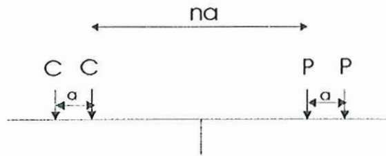
Imagen N° 5. Esquema de arreglo DIPOLO-DIPOLO realizado en el lugar. Fuente: Norma ASTM D – 6431.
