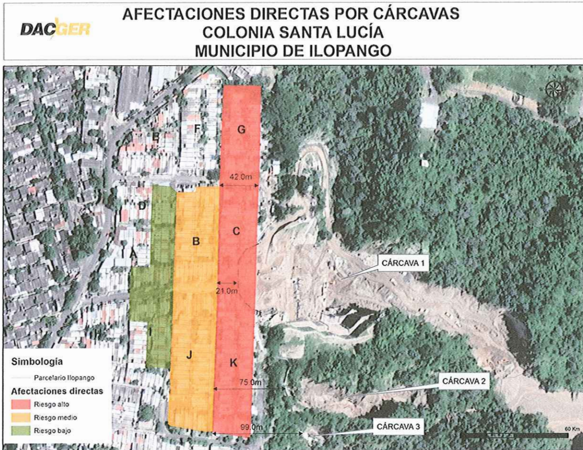
Imagen No. 1 Afectaciones directas y nivel de riesgo Fuente: DACGER
