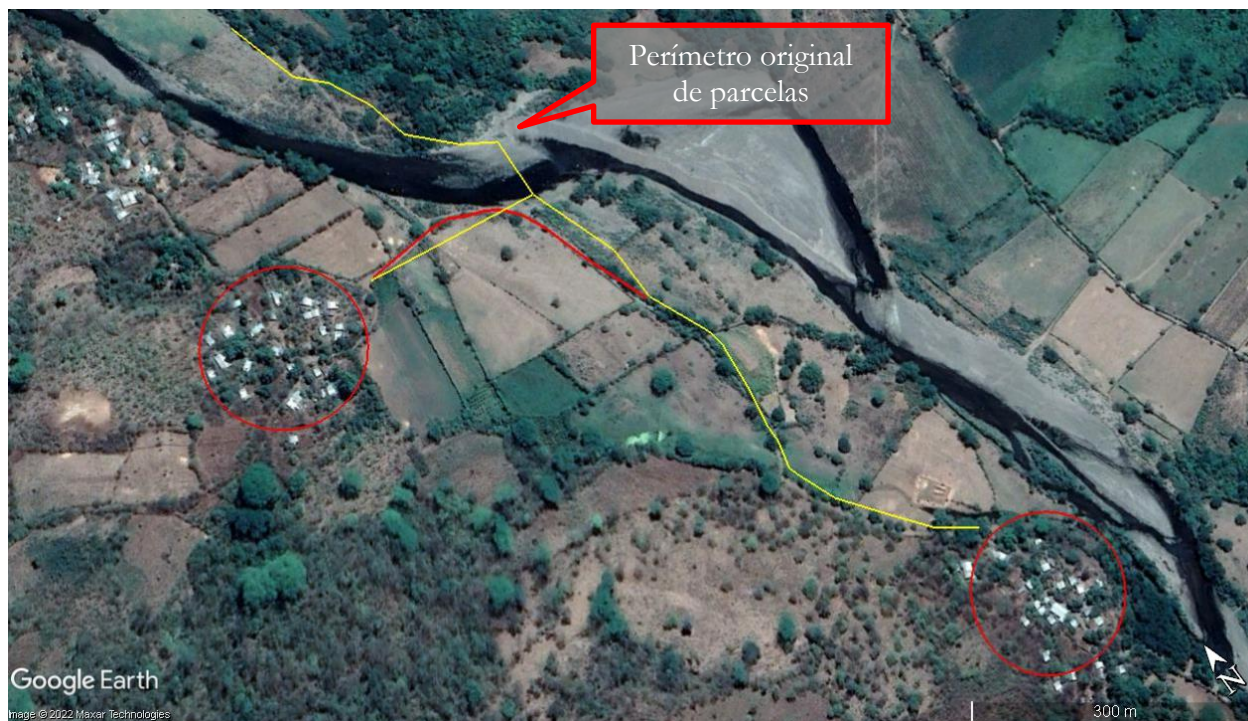
Imagen 7. Última imagen de satélite disponible en la actualidad, obsérvese en línea roja alineamiento de calle antes de Tormenta tropical Julia y erosión hacia margen derecho.
