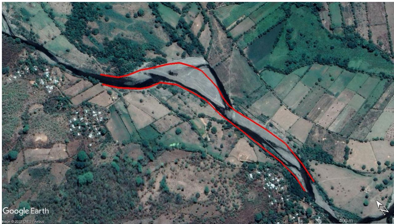
Imagen 8. Esquema representativo de zona a intervenir con la conformación de bordas y dragado de Río Acahuapa.
