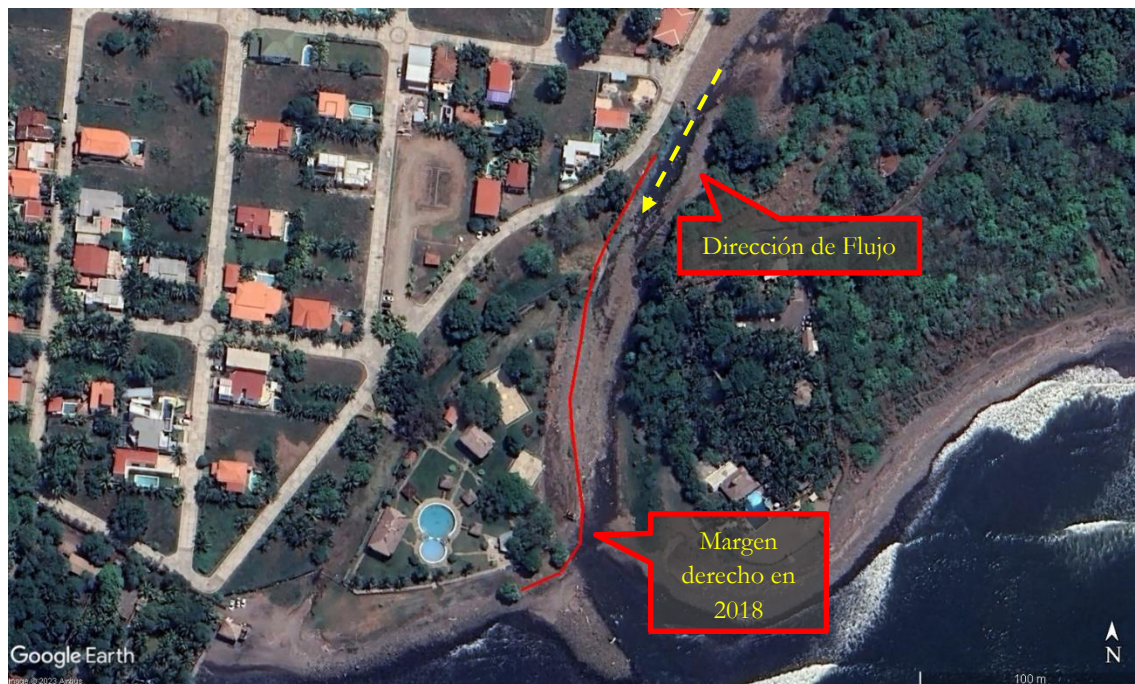
Imagen N° 4. Ubicación de margen derecho en 2023; erosión de hasta 20 m en dirección de Casa Club. Fuente: Imagen de Google Earth , julio 2023
