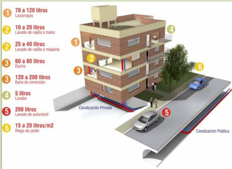
IMAGEN No. 2. Niveles de consumo de agua promedio a nivel de Latinoamérica en usos residenciales. FUENTE: Presentación Tomadores de Decisión; J.C. Bertoni.
