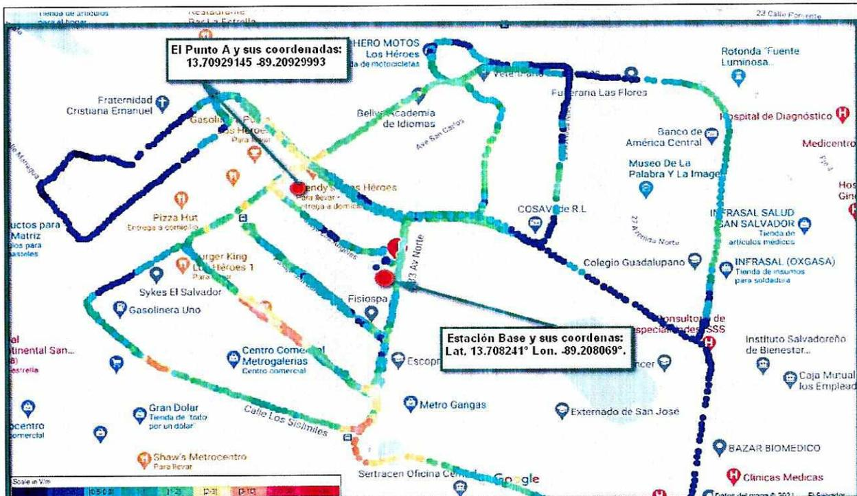
Imagen 5: Detalle de la ruta seguida en la campaña de mediciones de intensidad de campo en los alrededores de la estación radioeléctrica y el punto A en coordenadas LAT: 13.70929145, LON: -89.20929993, donde se midió el mayor nivel de campo eléctrico.
