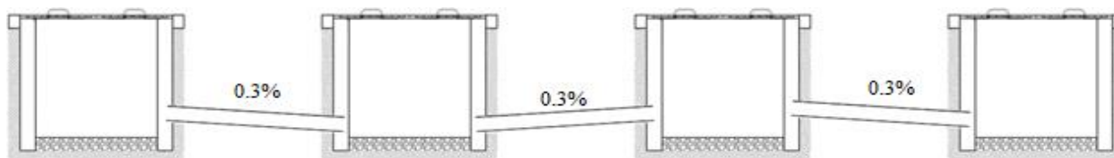
Imagen 3.8: Esquema ilustrativo de pendiente permitida de 0.3%
