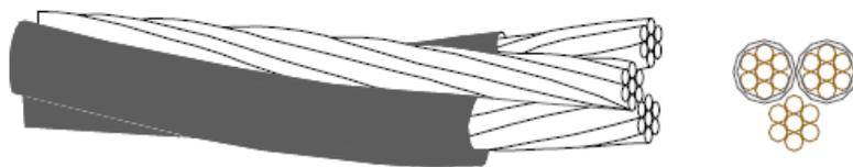
Imagen n.º 2. Forma esquemática del conductor triplex, obtenida de la ET3-330 del Acuerdo N.º 301-E-2003
